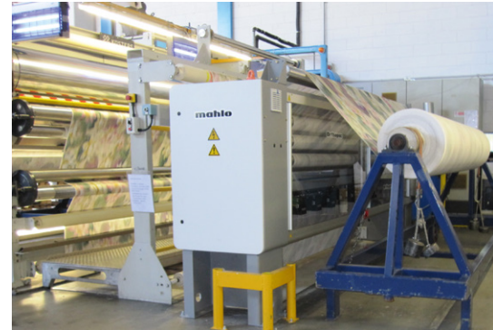
Orthopac RVMC、印刷工程のカレンダー入口に設置
