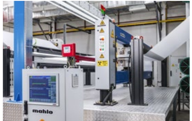
Qualiscan QMS のトラバーススキヤナが、重量、厚さまたは水分の幅方向プロファイル(CDプロファイル)と流れ方向プロファイル(Mdプロファイル)を正確に測定。これらはマールオペレーティングソフトウェアにより、タッチスクリーン画面で鮮明に表示されます。(写真手前)
