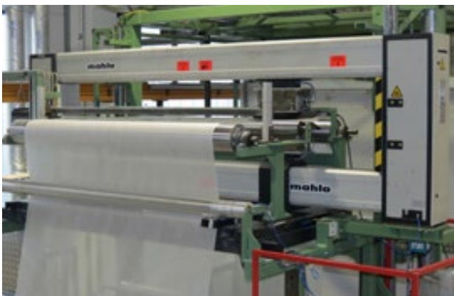
O-frame 型スキヤナ Webpro M に装着されたβ線センサGravimat DFIで、グラスファイバーと不織布のスクリーン補強材の重量を測定しています。
