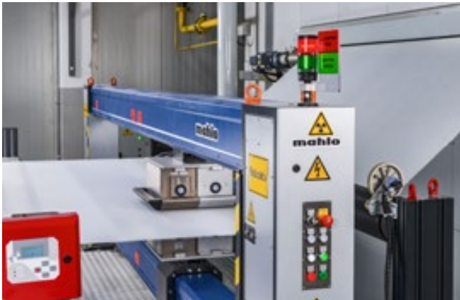
Qualiscan QMS のスキヤナ Webpro M がβ線センサで重量を、赤外線センサで水分率を測定しています。
