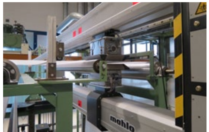
β線センサはアイトープの放射線で重量を測定します。DFI 技術により、測定ギャップ通過時のウエブ上下変動には全く影響を受けません (Dynamic Flutter Independent)。最小単位のβ線源で最高の測定機能を発揮します。
